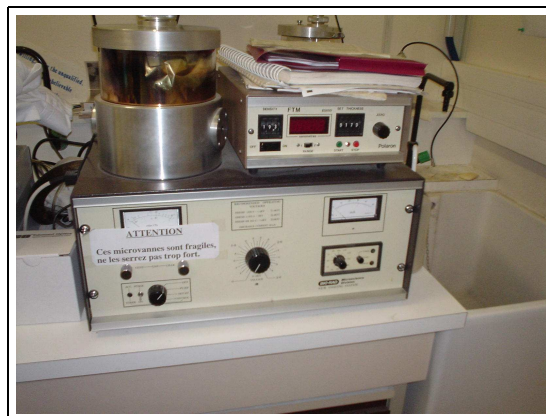
FIG. 3 – Dépôt d'une couche d'or sur l'échantillon
